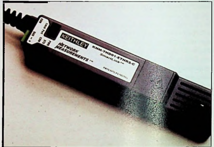
SmartLink™ module met ingebouwde sensoren voor temperatuur en vochtigheid
