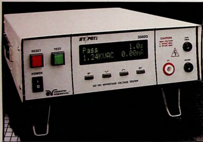
Afb. 4 Gecombineerde AC/DC 0 - 5 kV 'Hipot met Earth Continuity'-test
